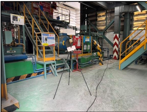
ภาพที่ 3.41 การตรวจวัดระดับเสียงบริเวณ เครื่องจักรบริเวณหม้ออบ Pet Coke
