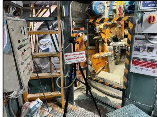
ภาพที่ 3.56 การตรวจวัดฝุ่นละอองในสถานที่ทำงานบริเวณเครื่องบรรจุผลิตภัณฑ์
