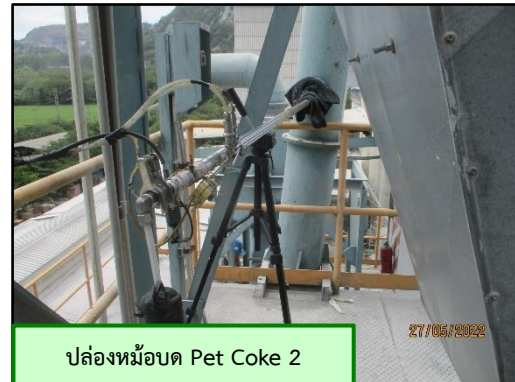
ภาพที่ 3.5 การตรวจวัด TSP จากปล่องหม้อบด Pet Coke 1 และ 2
