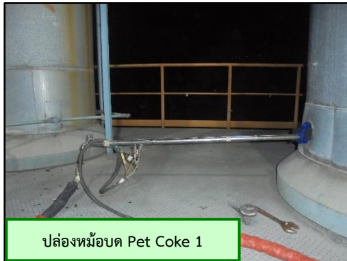
ภาพที่ 3.5 การตรวจวัด TSP จากปล่องหม้อบด Pet Coke 1 และ 2
