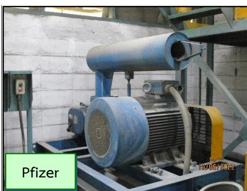
ภาพที่ 3.45 ห้องเก็บเสียงของ Blower และ Pfizer สำหรับป้องกันเสียงจากกระบวนการผลิต
