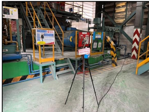
ภาพที่ 3.57 การตรวจวัดฝุ่นละอองในสถานที่ทำงานบริเวณหม้ออบ Pet Coke
